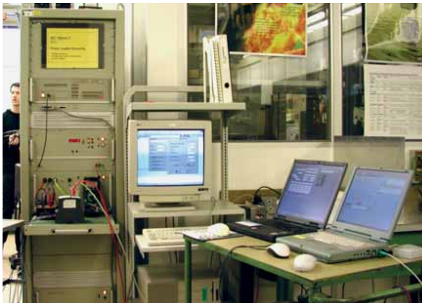
Messung des Verhaltens der Geräte bei Spannungseinbrüchen, Kurzzeitunterbrechungen oder Spannungsschwankungen der Hilfsenergieversorgung
